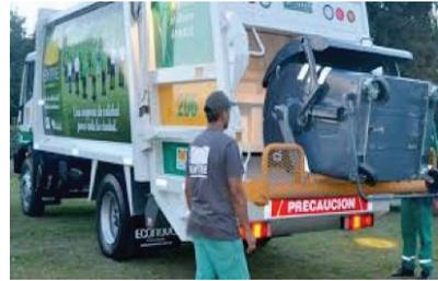
Figura 4.14 y 4.15 Camiones de carga posterior y con sistema de alzacontenedores
