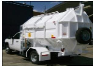
Figura 4.16 Camiones de carga lateral
