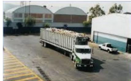
Figuras 4.23 y 4.24 Trailers de transferencia con cajas sin compactación
